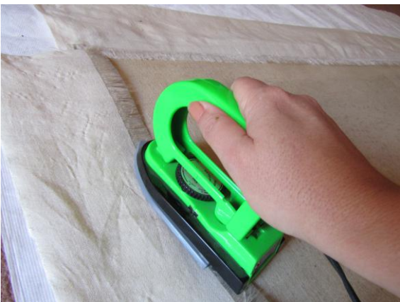
Adhesión de bandas de tensión
